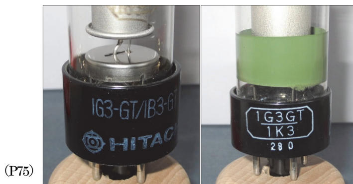
第 90 図 高圧整流管 (1G3-GT) のグリーンベルトの例
