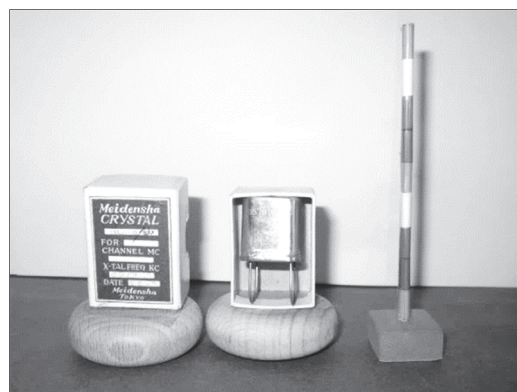
第153図 色副搬送波（3.579545MHz）発振用、 HC6/U型水晶振動子（1961,昭和36年製） （口絵）
