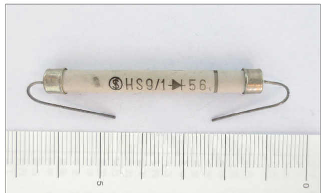
第159図 高圧整流用セレン整流器
